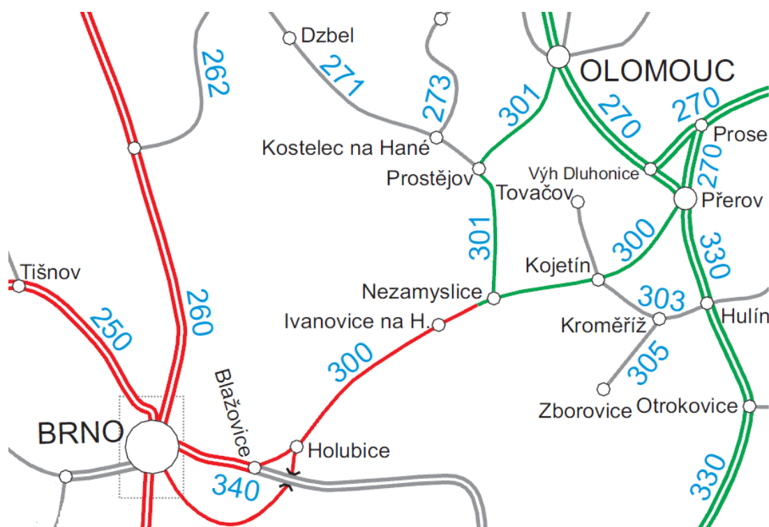
Systém trakčního napájení tratí – stávající stav 1
